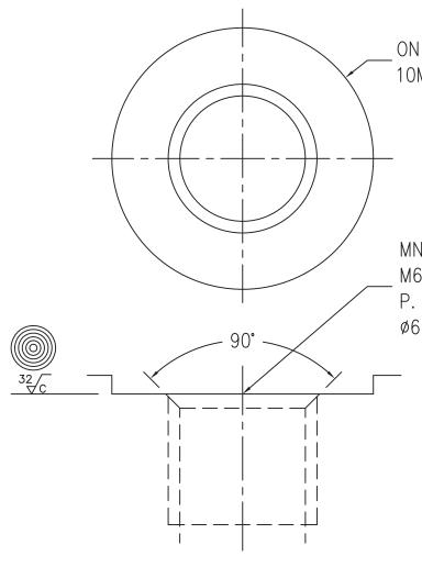
ON ROUNDED SURFACES PROVIDE A 10MM (.394) MIN SPOT FACE
